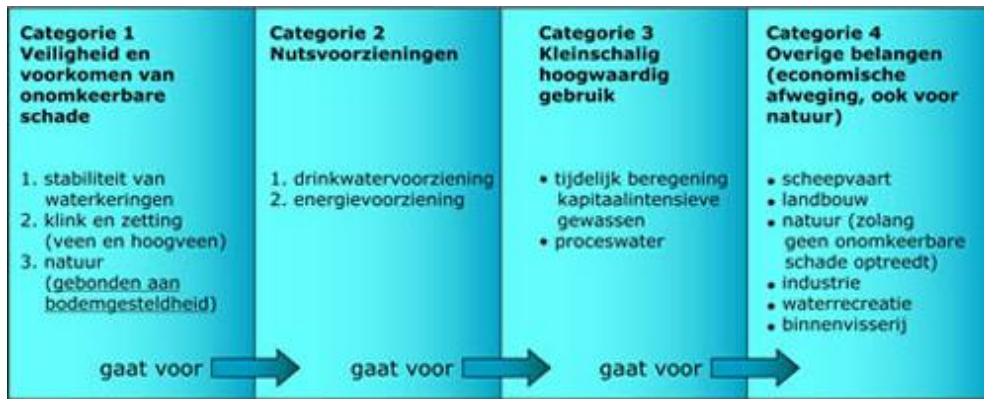
figuur 8.10 Verdringsreeks die gebruikt wordt in geval van extreme droogte
