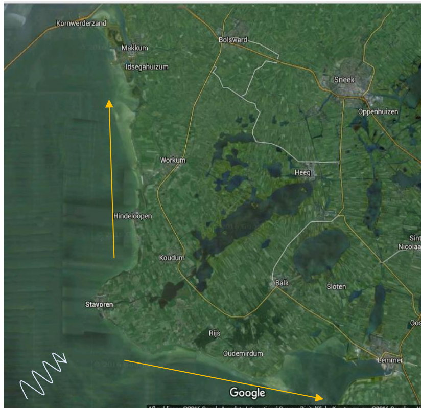
figuur 6.8 De overheersende windrichting uit het zuidwesten (kronkellijn) veroorzaakt netto zandtransport langs de Friese kust (gele lijnen)
